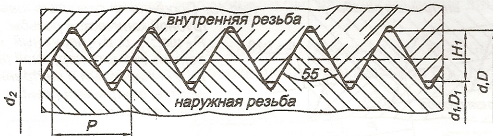
Рис. 15. Профиль и основные параметры дюймовой резьбы:
