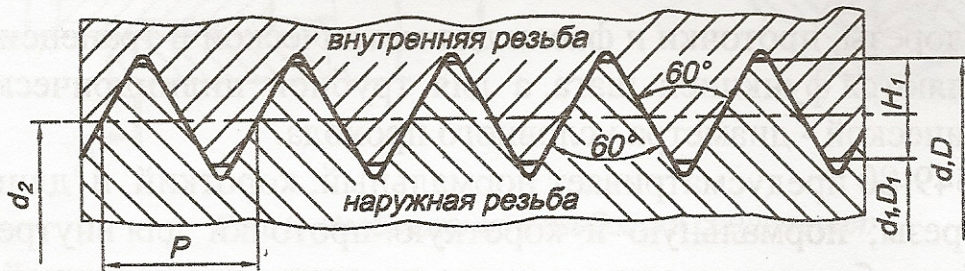
Рис.9. Профиль и основные параметры метрической резьбы:
