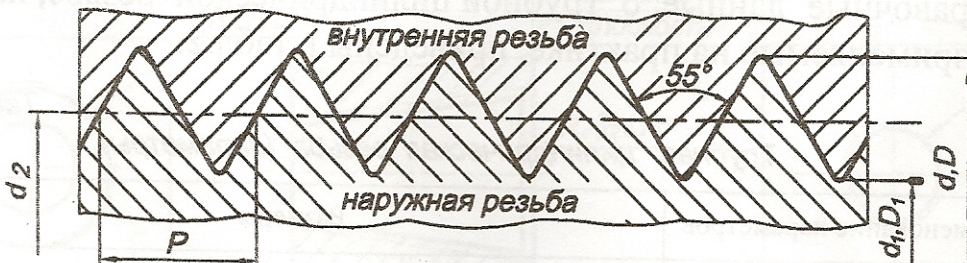
Рис. 11. Профиль и основные параметры трубной цилиндрической резьбы: P - шаг; d, d 1 - наружный и внутренний диаметры наружной резьбы; D, D 1 - наружный и внутренний диаметры внутренней резьбы; d 2 - средний диаметр резьбы.
